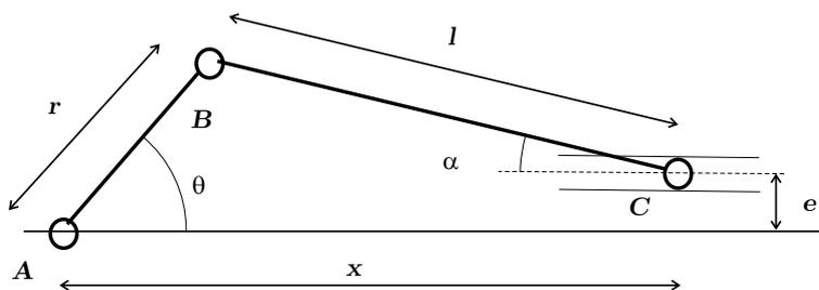
FIG. 2 Calcul de la position d'un piston
