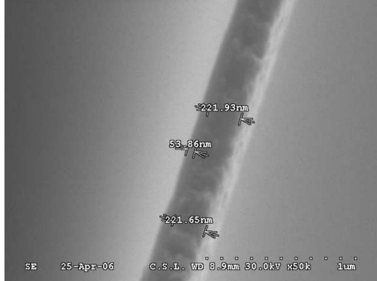
FIG. 5.2: Vue de l'épaisseur du filtre aluminium-polyimide
