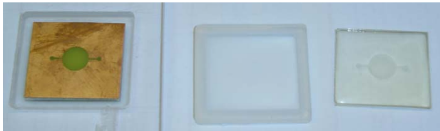
FIG. 9.6 – Fabrication d'une pièce: gabarit positif, moule en RTV-2 et pièce en résine époxy.
