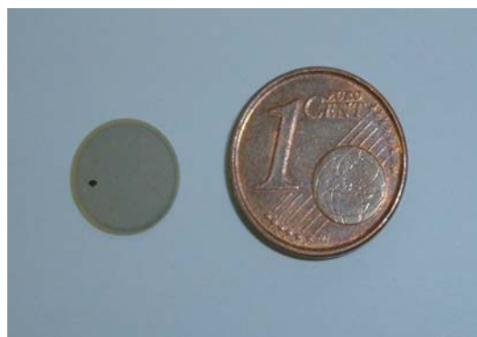
FIG. 9.4 – Échantillon d'un disque en PXE – 5 de 5mm de rayon et épais de 200 \mu m , avec électrode en nickel (Morgan).
