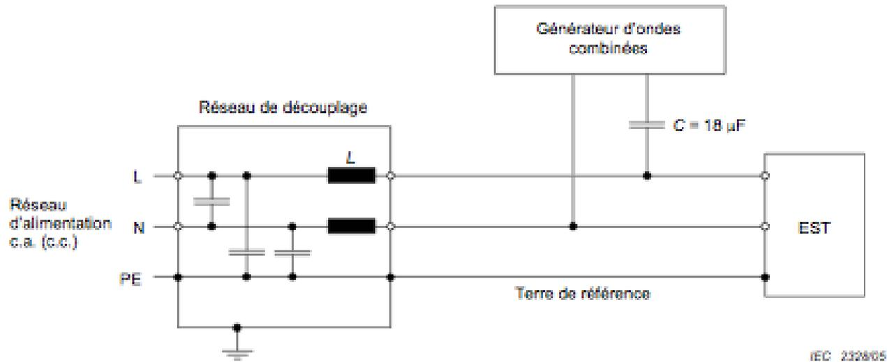
Figure 7 – Exemple de montage d'essai de ligne à couplage capacitif sur lignes à c.a./c.c.; couplage entre fils (conformément à 7.2)
