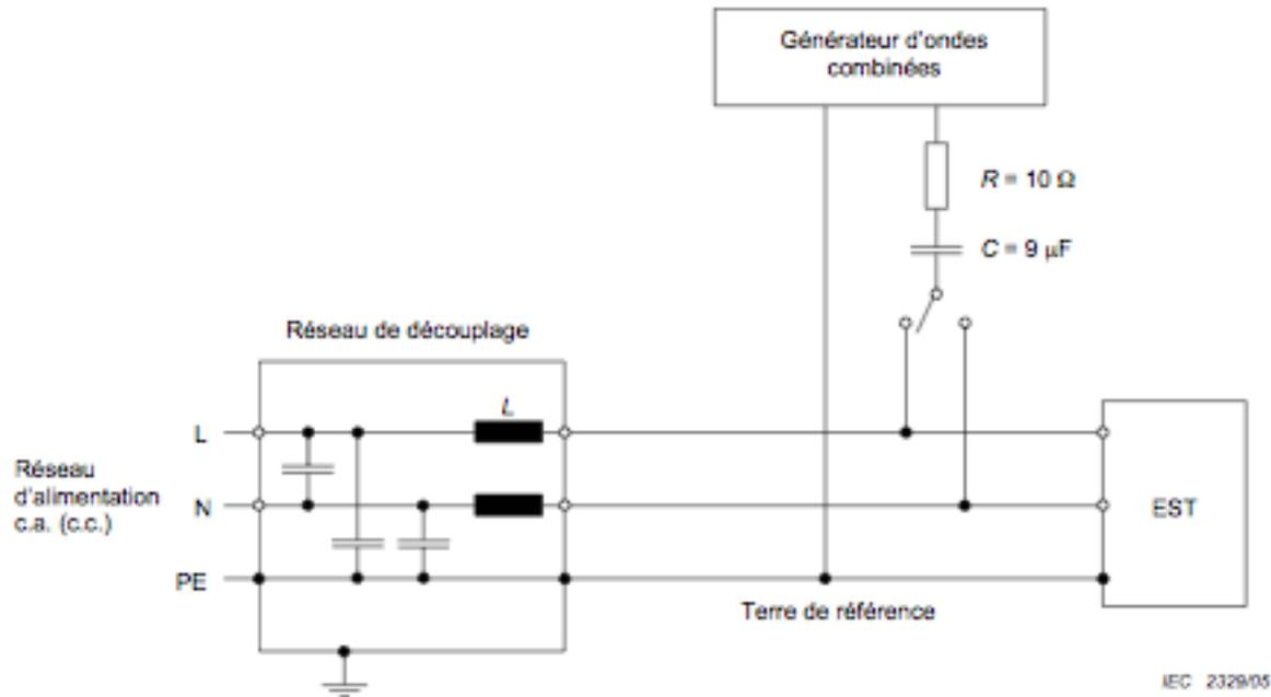
**Figure 8 – Exemple de montage d'essai de ligne à couplage capacitif sur lignes à c.a./c.c.; couplage entre un fil et la terre (conformément à 7.2)**
