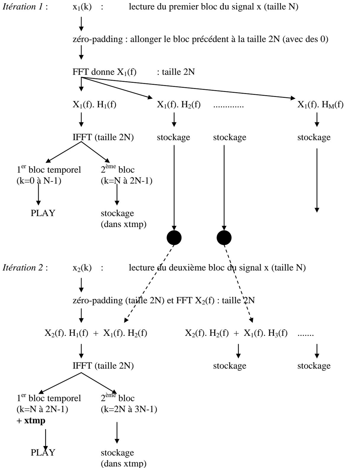
Cet algorithme permet donc de jouer le produit de la convolution avec un délai d'un seul bloc de taille N.
