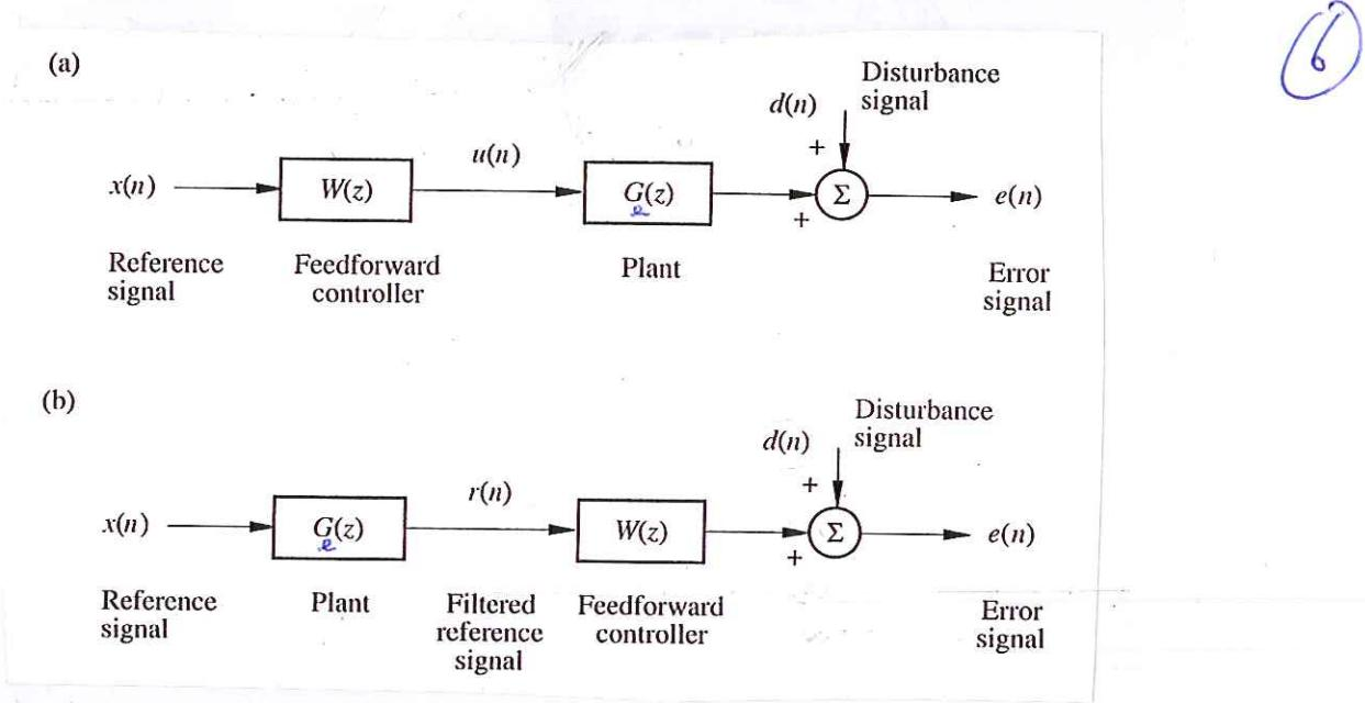
La permutation des fonctions de transfert  $W(z)$  et  $G(z)$  est permise si les deux systèmes sont linéaires et invariants dans le temps.
