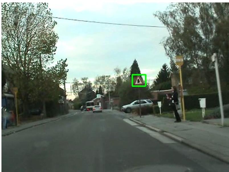
FIG. 5.23 – Marquage d’un objet détecté. La cascade de classeurs utilisée a été entraînée sur un ensemble d’apprentissage dans lequel les signaux sont recentrés.
