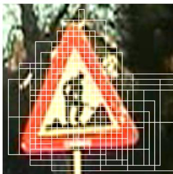
FIG. 5.18 – Représentation, sur une image de signal, des filtres de HAAR sélectionnés dans les 5 premiers étages d'une cascade particulière.
